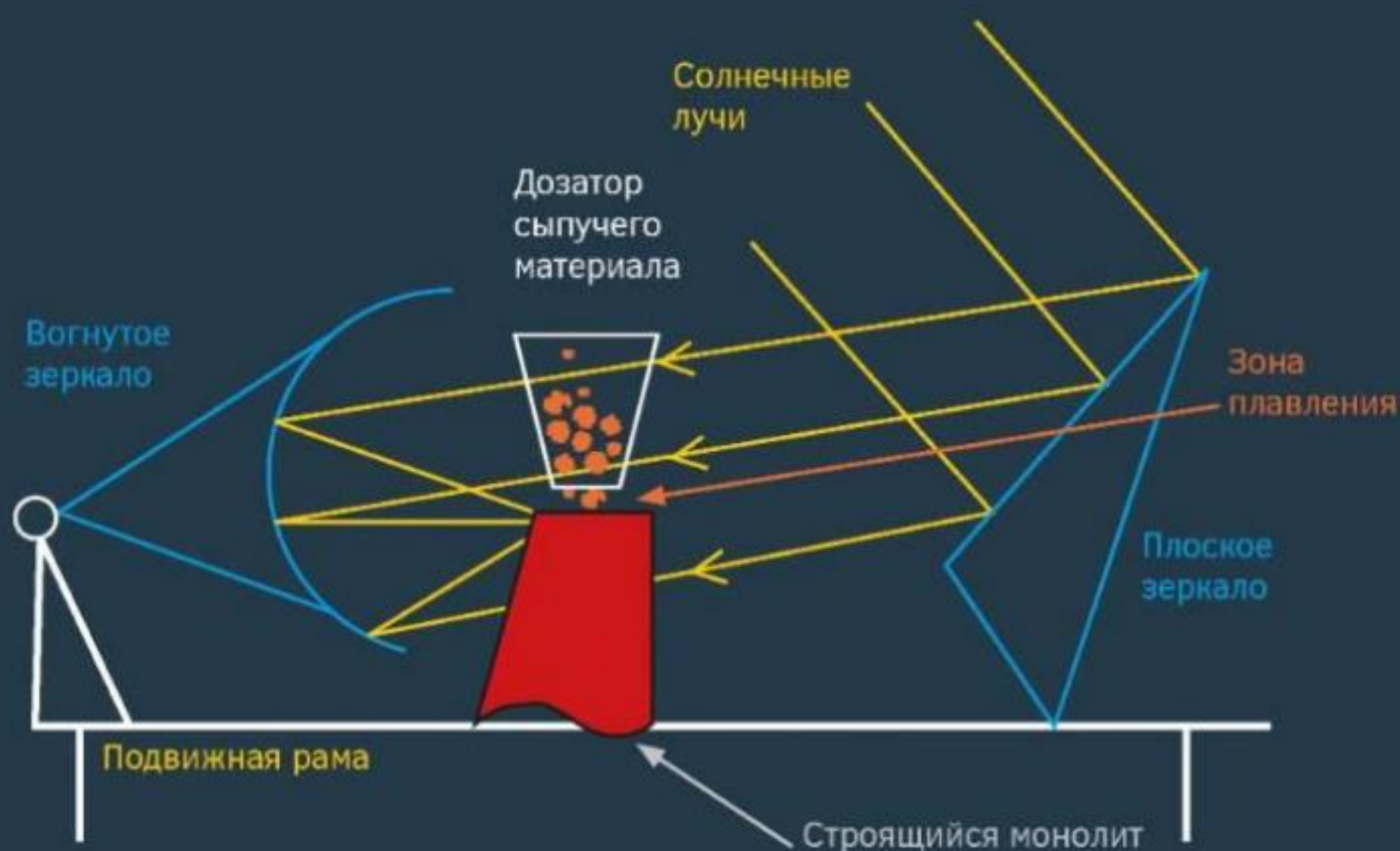
Рис. 4. Концепция строительного 3D-принтера на солнечной энергии
