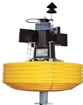
Буйковая станция SMKF1 наблюдательной сети NOAA для измерения температуры поверхности океана, температуры, влажности воздуха и скорости ветра в приводном слое воздуха во Флоридском проливе в Мексиканском заливе.
