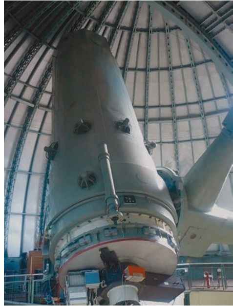
1.93-м рефлектор обсерватории От-Прованс (Haute-Provence), Франция, установленный в 1958 г., со спектрографом ELODIE. На этом инструменте открыто 20 экзопланет (включая 51 Peg). Изображение: Wikipedia
