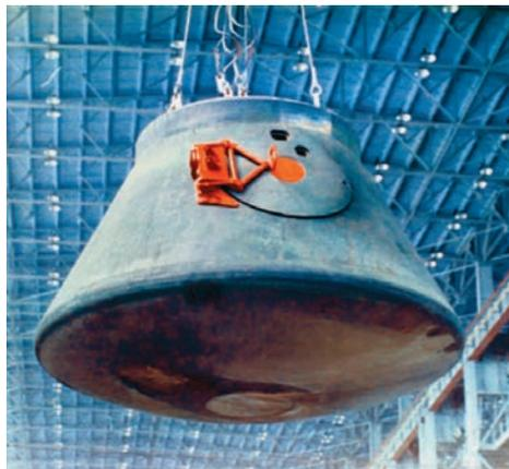
*Теплозащита отсека экипажа ВА
