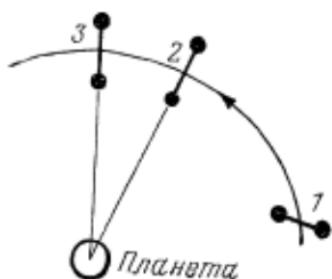
Рис. 25. Различные положения ориентатора гантельного типа на орбите
