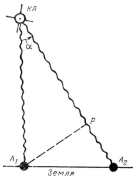
Рис. 26. Определение орбиты корабля по радионаблюдениям
