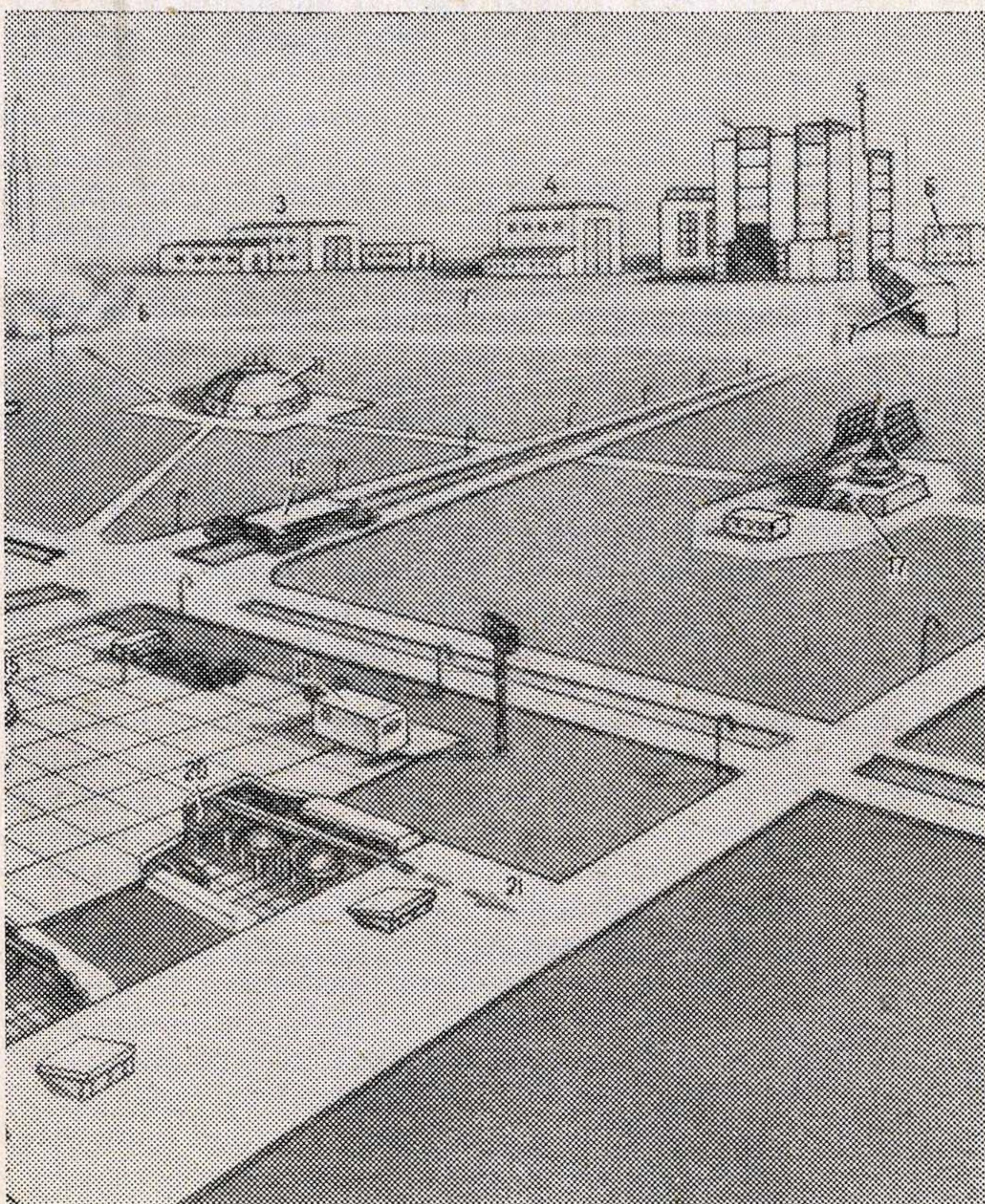
кабель-заправочная башня; 2 — башня обслуживания; 3 — тяжело-испытательный корпус космических объектов; 5 — зданиеносной командный пункт; 8 — хранилище и заправочная системы пожаротушения; 11 — командный пункт; 12 — газома; 15 — башня для приборов наведения ракеты по азимуту; 18 — укрытие для расчета; 19 — хранилище и заправочного водорода; 21 — пути к испарительным площадкам.
