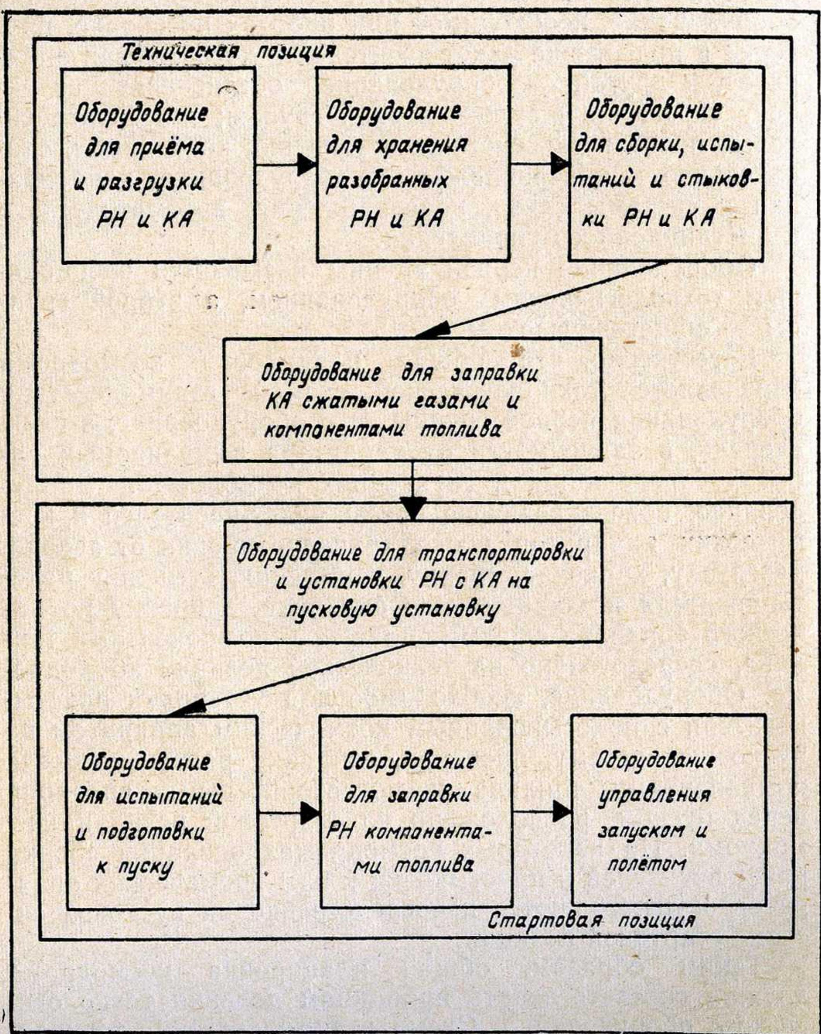
Рис. 1. Схема взаимодействия технологического оборудования.
