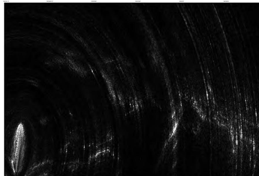
Рисунок 5.2.41. Радиолокационное изображение (РЛИ) местности, полоса частот 30 МГц, режим излучения ЛЧМ импульсов, шаг пикселей 5x5 м, маршрут № 4, время синтеза 30 с
