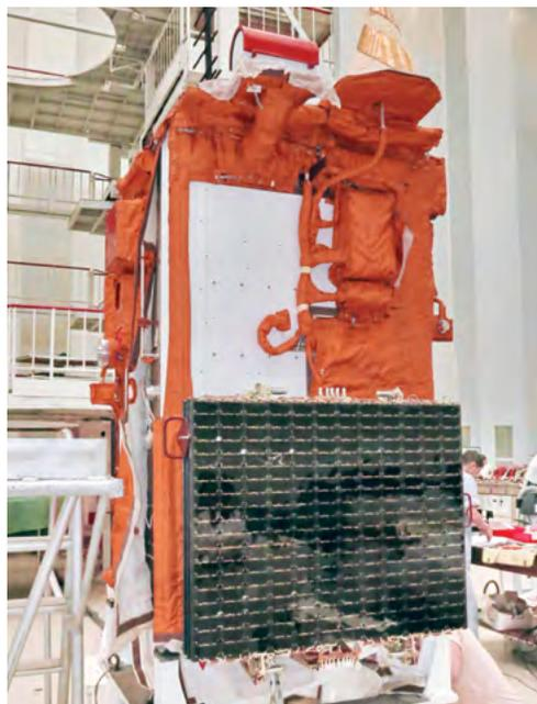
Рисунок 1.3.3.4. Фото БС, установленной на МКА «АИСТ-2Д»
