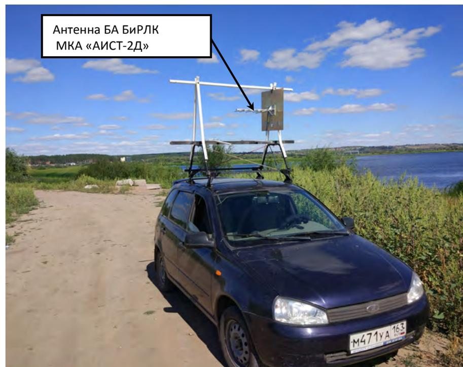
Рисунок 5.2.38. Передающая позиция,двигающаяся в процессе излучения по автомобильному мосту через реку Сок
