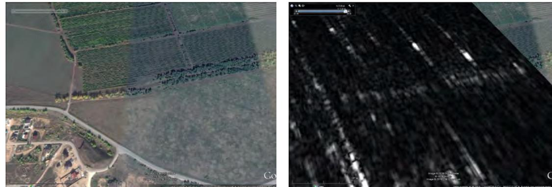
Рисунок 5.2.44. РЛИ лесной посадки (справа), оптическое (слева), полоса частот 30 МГц, режим излучения ЛЧМ импульсов, шаг пикселей 5x5 м
