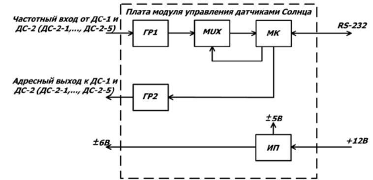
Рисунок 1.5.4.20. Структурная схема модуля управления датчиками Солнца
