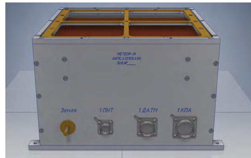
Рисунок 1.5.3.2. Детектор микрометеороидов и частиц космического мусора
