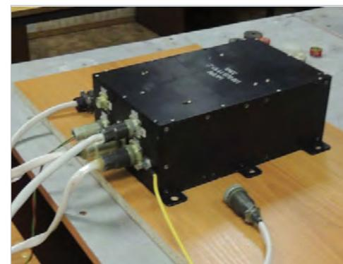
Рисунок 1.5.5.3. Внешний вид блока КМСС
