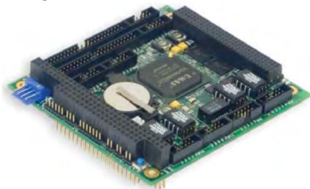
Рисунок 1.5.4.4. Общий вид одноплатного компьютера в формате PC/104 на базе процессора Vortex
