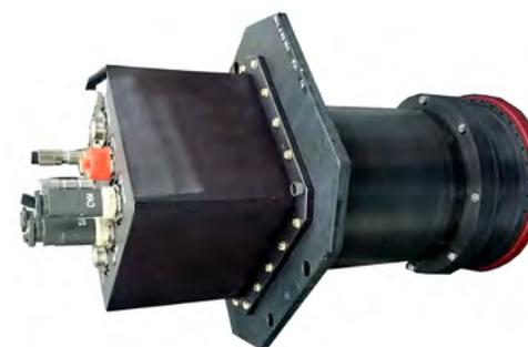
Рисунок 1.4.4.3. КОЭ-ИКД – инфракрасная оптико-электронная камера
