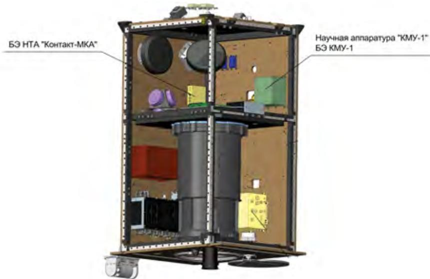
Рисунок 1.5.1. Размещение блоков научной аппаратуры на корпусе МКА, вид (г)
