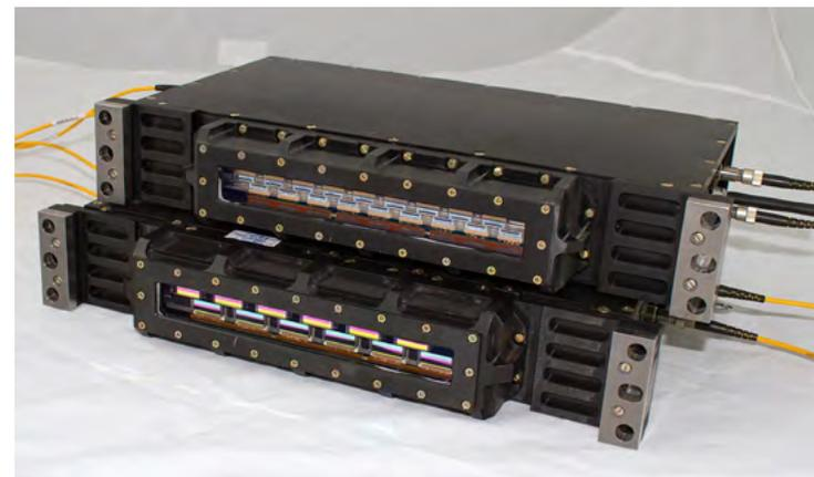
Рисунок 1.4.3.11. Блоки ОЭП-АПХ (сверху) и ОЭП-АМС (снизу) комплекса целевой аппаратуры МКА «АИСТ-2Д»
