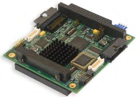
Рисунок 1.5.4.6. Внешний вид модуля видеопроцессора VIM301
