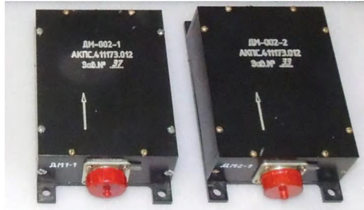
Рисунок 1.5.4.12. Внешний вид магнитных датчиков
