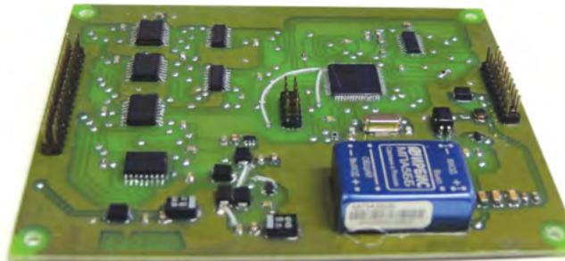
Рисунок 1.5.4.19. Внешний вид платы модуля управления датчиками Солнца
