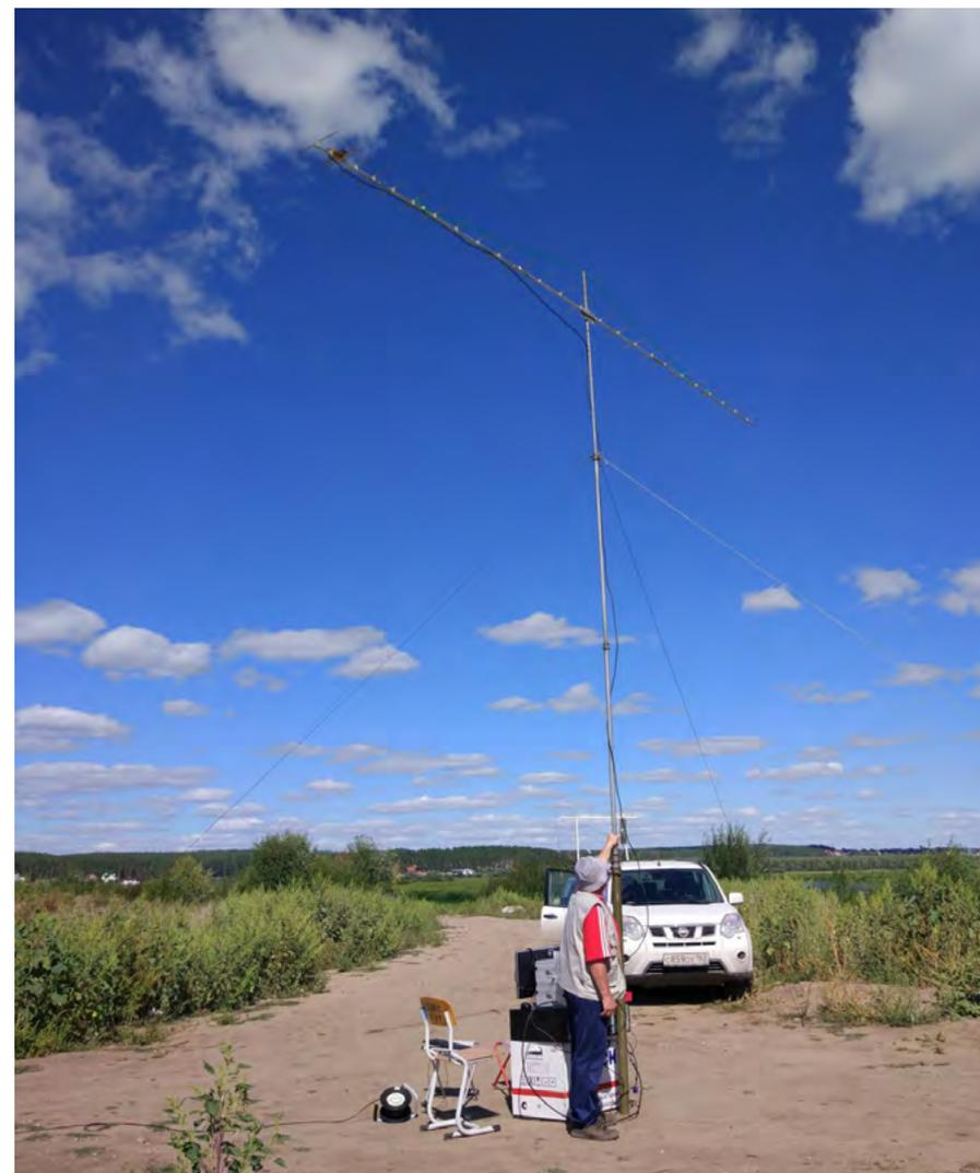
Рисунок 5.2.39. Антенна отраженного канала на приемной позиции
