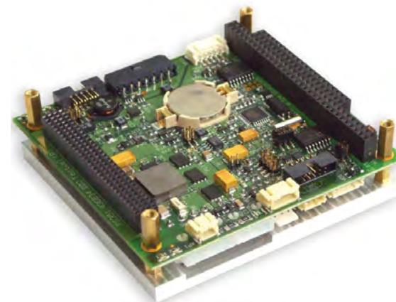
Рисунок 1.5.4.5. Модуль источника питания PS151
