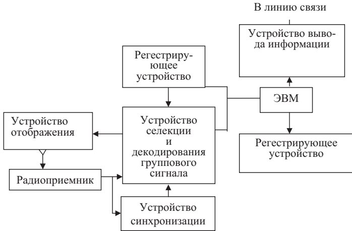
Рис. 10.7. Состав приёмно-регистрающей аппаратуры и аппаратуры обработки информации
