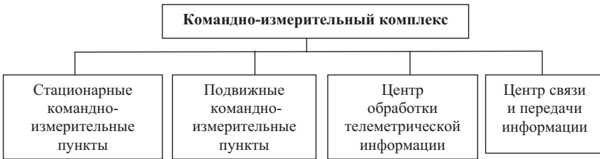
Рис. 3.4. Состав основных объектов командно-измерительного комплекса
