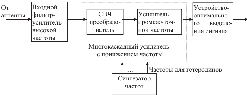
Рис. 4.12. Типовая структурная схема приемника КИС
