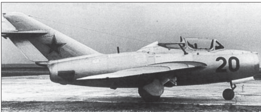
Самолет-тренажер катапульты УТИ МиГ-15СТК UTI MiG-15STK parachute eject mechanism trainer airplane
