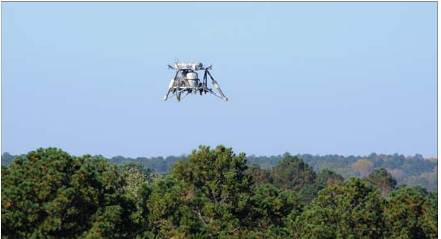
Прототип роботизированного посадочного модуля НАСА под названием Mighty Eagle, построенный инженерами Центра космических полётов Маршалла, недавно завершил серию тестов, призванных проверить работоспособность систем робота, возвращающегося к активной деятельности после продолжительной зимней спячки.
