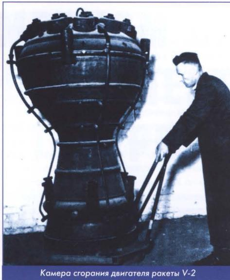
Камера сгорания двигателя ракеты V-2
