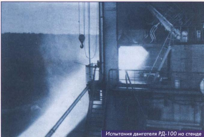
Испытания двигателя РД-100 на стенде
