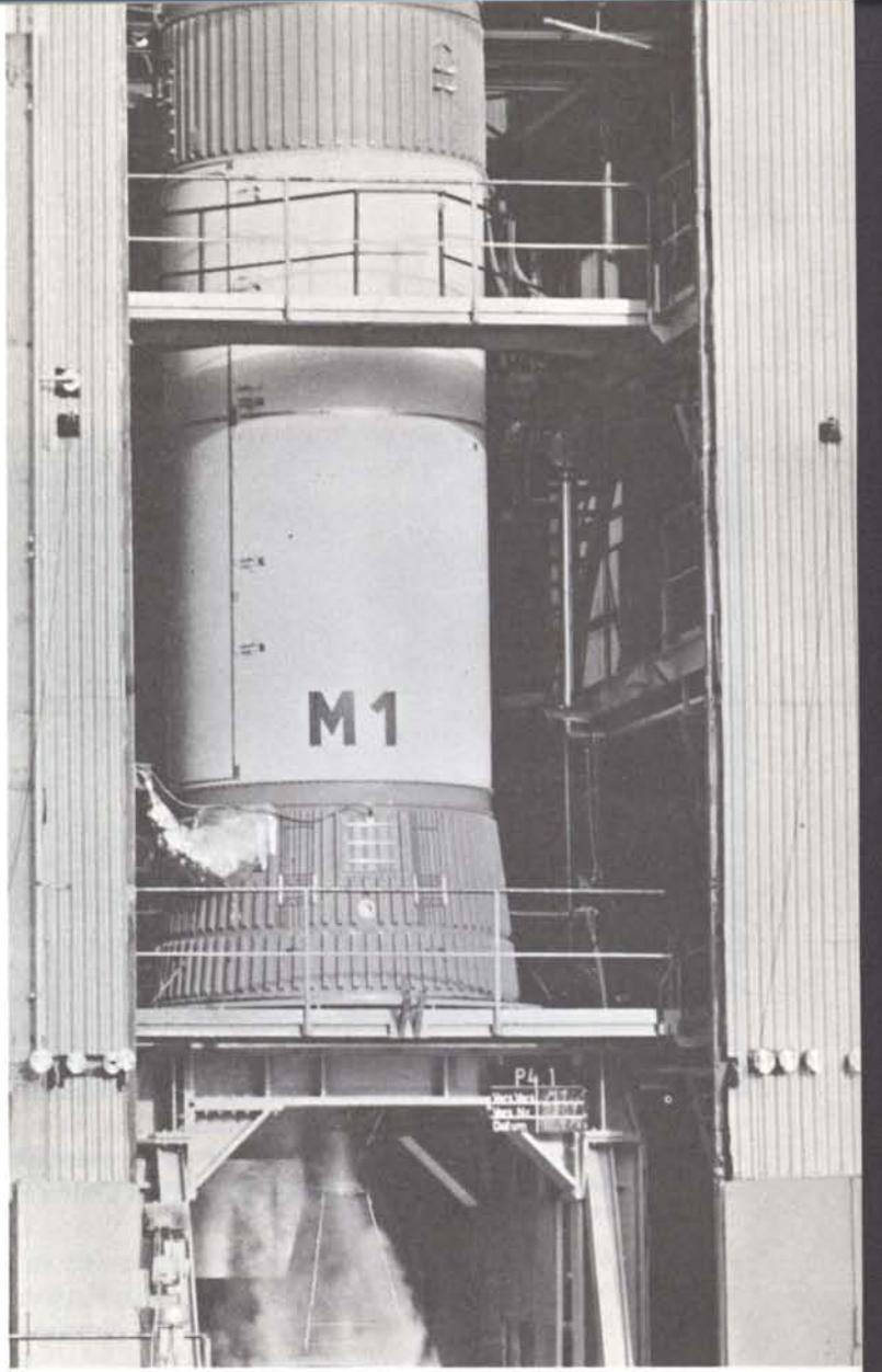
*Figure 7 – First test firing of the second stage at Hardthausen (Germany)/Premier essai du deuxième étage à Hardthausen (Allemagne).*
