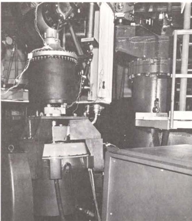
Figure 3 – Essai en configuration L140. Vue d'un excitateur 18 000 N du transmetteur et d'un moteur maquette.
