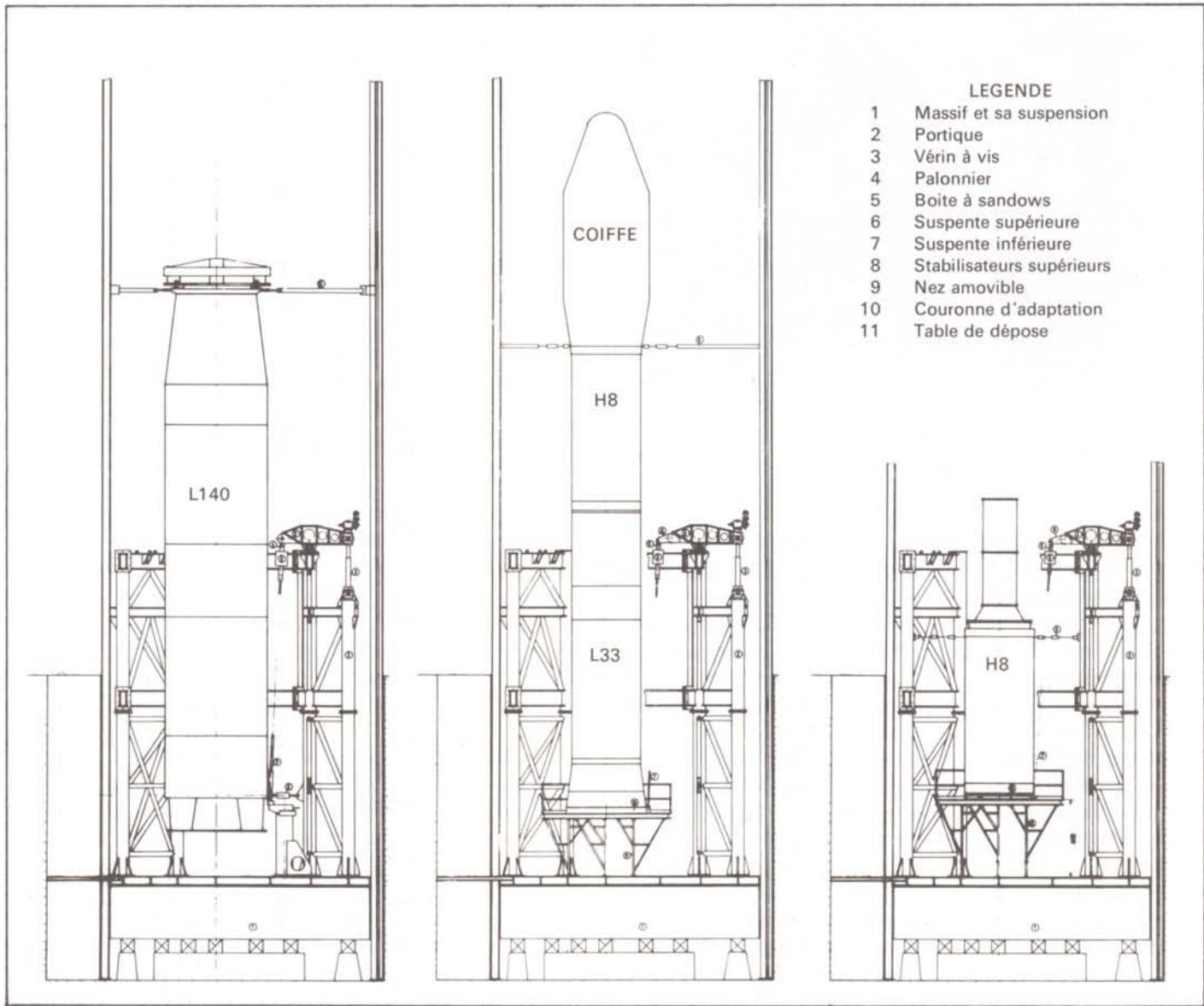
Figure 5 – Configurations des maquettes dans le dock 3 du SIL.
