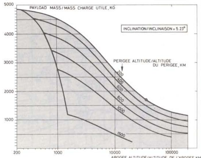
Figure 3 – Payload mass as a function of apogee altitude for an eastward launch / Masse de la charge utile en fonction de l'apogée pour un lancement plein Est.
