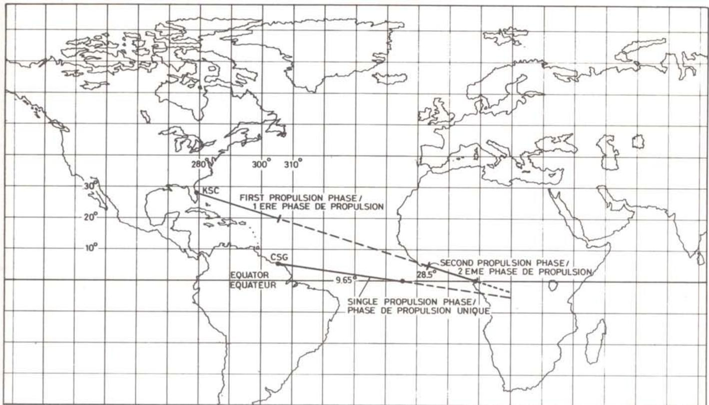
**Figure 2 – Launch sequences from the Guiana Space Centre (CSG, Kourou) and from Kennedy Space Center (KSC, Cape Canaveral) and the inclinations of the corresponding transfer orbits / Séquences de lancement à partir du Centre spatial guyanais (CSG, Kourou) et du Centre spatial Kennedy (KSC, Cap Canaveral) avec les inclinaisons d'orbite correspondantes.**
