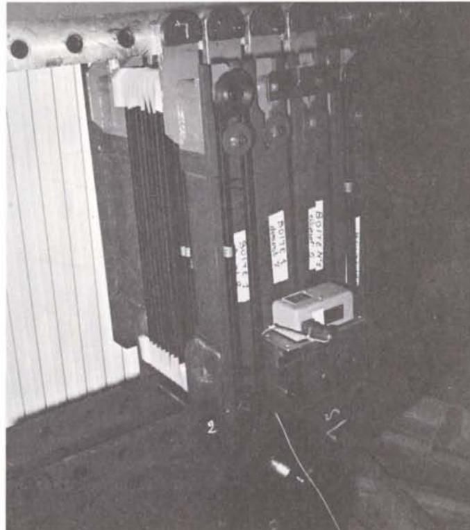
Figure 2 - Essai en configuration L33. Vue d'une boîte à sandows de la suspension avec son capteur de déplacement qui mesure l'élongation.
