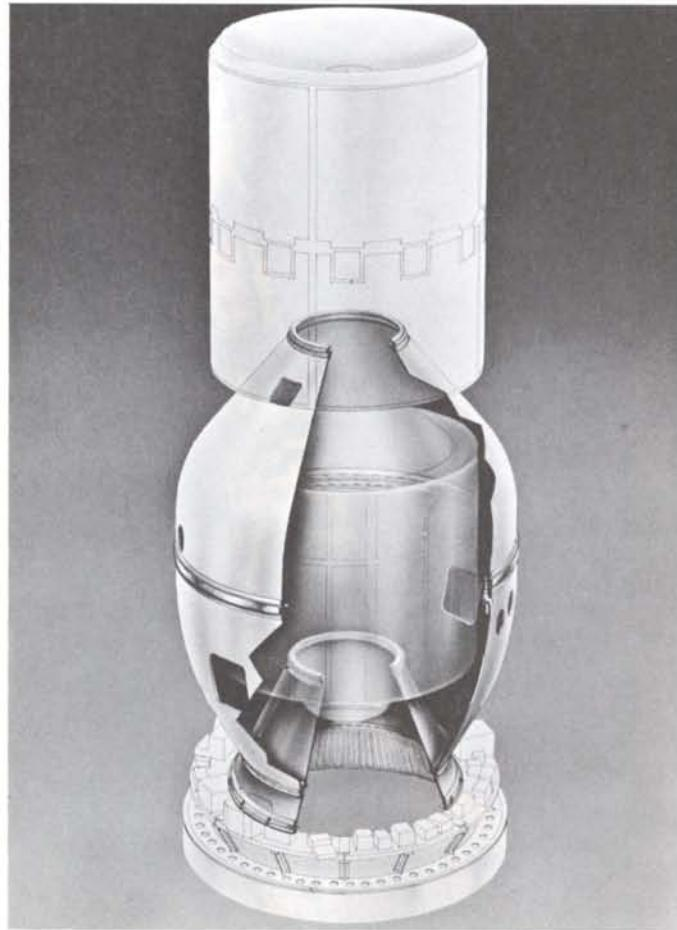
Figure 1 – The Sylda (Système de Lancement Double Ariane) system.
