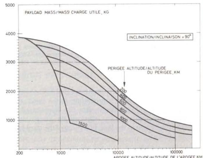
Figure 4 – Payload mass as a function of apogee altitude for a northward launch / Masse de la charge utile en fonction de l'altitude de l'apogée pour un lancement plein Nord.
