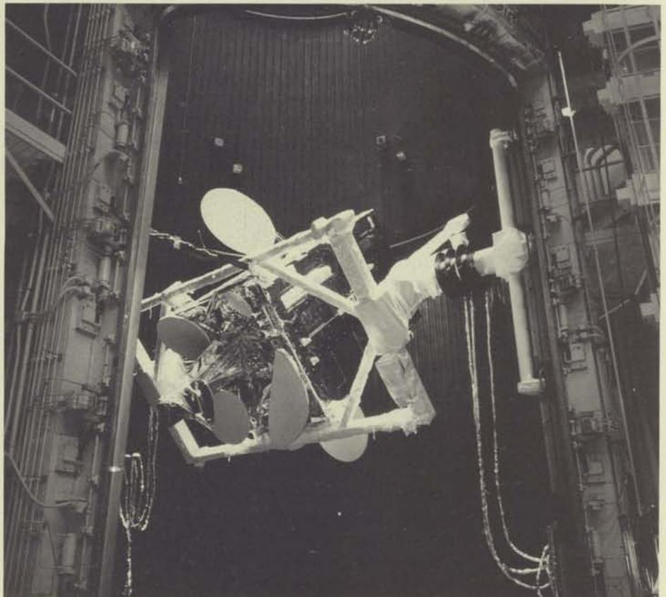
*Intégration du module de propulsion de modèle mécanique d'Olympus chez BAe à Stevenage*
