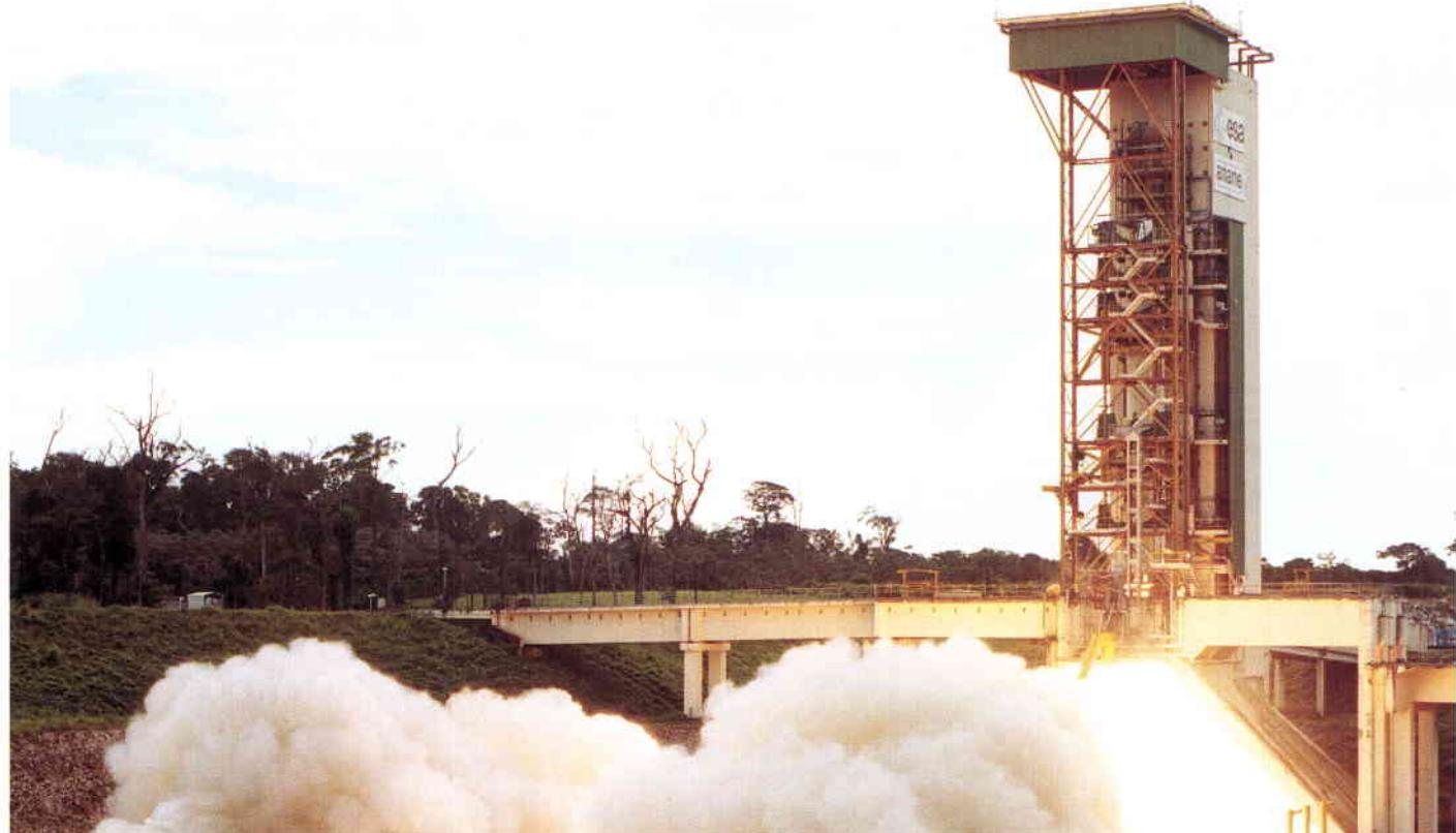
et se poursuit en octobre par deux essais de longue durée. L'ensemble des circuits fluides et électriques de l'ELA-3 est donc validés par cet exercice. La fabrication des éléments de l'étage pour le premier vol d'Ariane-5 se poursuit conformément au planning avec par exemple la livraison de la jupe avant et du bâti-moteur et la fin de soudage des réservoirs LOX et LH<sub>2</sub>.
