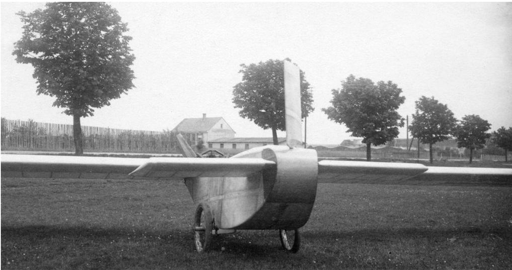
Die Deicke „Ente“ wurde 1922 fertiggestellt und hatte als Antrieb einen alten Anzani-Dreizylindermotor. Die Maschine besaß nicht nur ein vornliegendes Höhensteuer sondern auch ein auf dem Bug angeordnetes Seitenruder, das als Pendelruder konzipiert war. Dadurch entstand stärker als bei anderen Entenflugzeugen der Eindruck einer rückwärts fliegenden Maschine. Unter dem Rumpfheck sorgte eine große Seitenflosse für die nötige Richtungsstabilität um die Hochachse.
