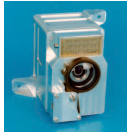
Die Kamera ROLIS ist an der Unterseite von Philae angebracht und fotografiert den Abstieg der Sonde und den Boden darunter. The ROLIS camera, installed at the bottom of Philae, will take photographs of the descent and of the ground underneath the probe.
