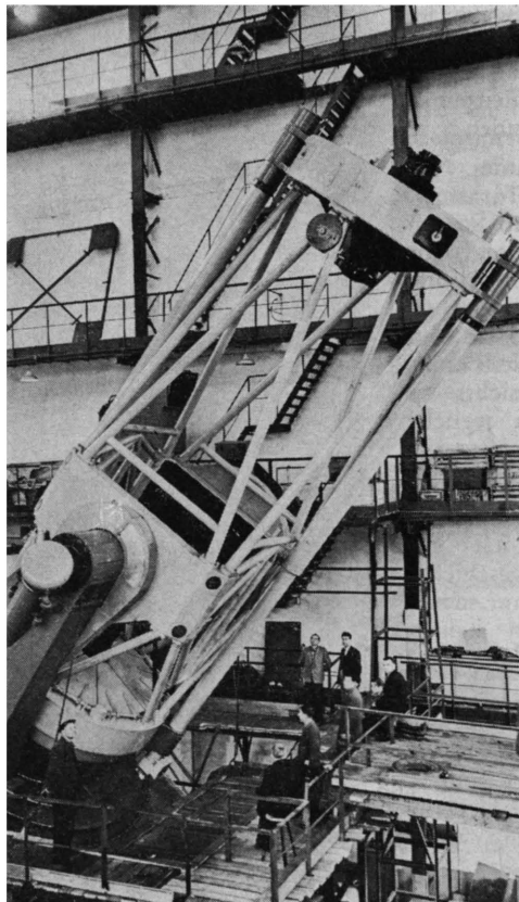
Das astrophysikalische Observatorium auf der Krim besitzt ein Teleskop mit einem Spiegel von 2,6 Meter Durchmesser und einer Brennweite von zehn Meter. Eine zusätzliche Anlage ermöglicht es, die Brennweite von zehn bis hundert Meter zu verändern. Das Teleskop arbeitet mit Hilfe einer Vielzahl von Elektromotoren und Rechenanlagen automatisch. Sein Gesamtgewicht beträgt 62 Tonnen
