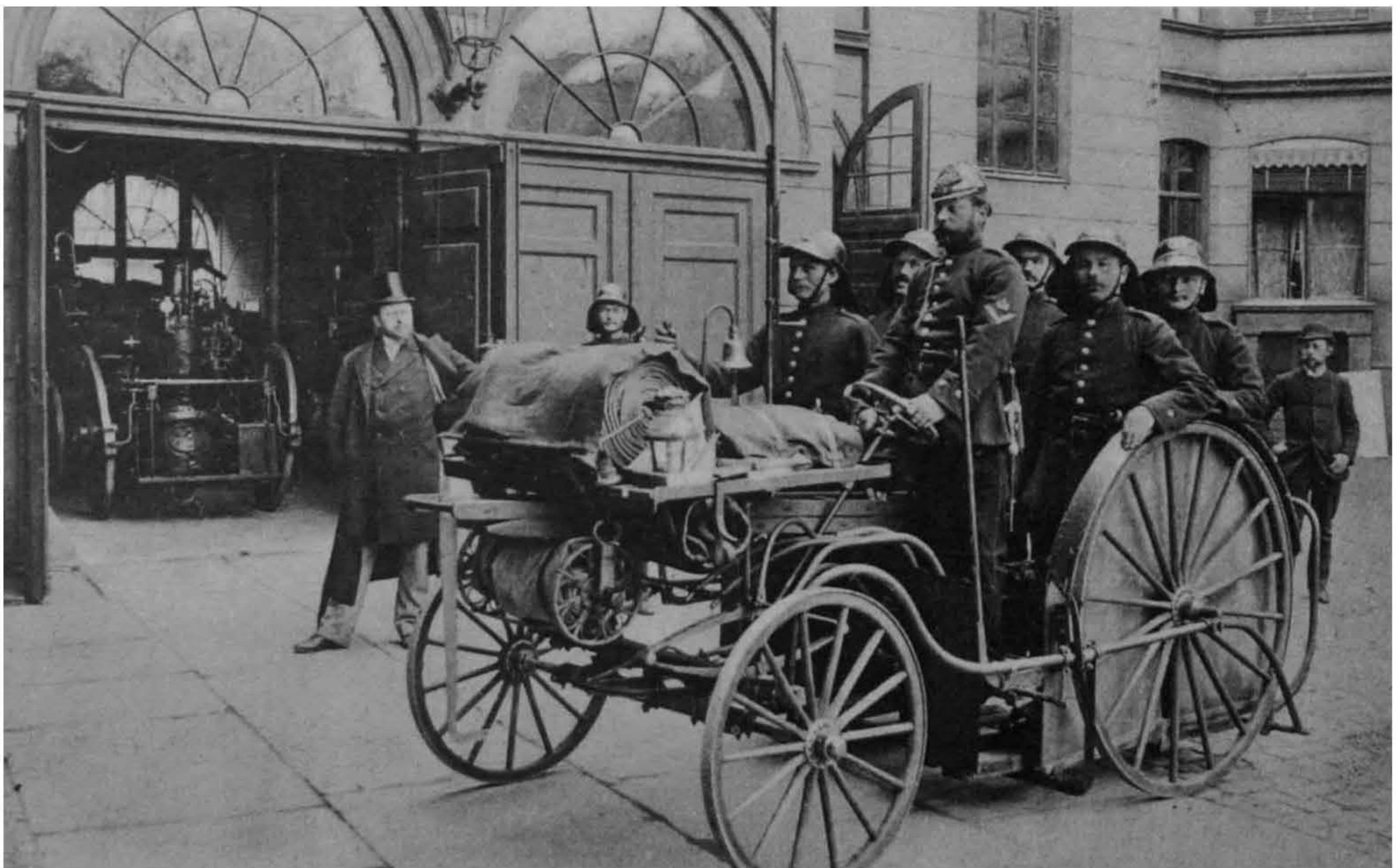
Diesen Tretmotorwagen ließ sich die Berliner Feuerwehr 1894 von Ganswindt bauen. — Der Benzinmotor war damals noch nicht gebrauchsfähig, und so baute der Erfinder den Tretmotor in dutzender Anwendungsförm. Ungeheures Aufsehen erregten solche Vehikel bei ihren Fahrten; das neugierige Publikum verstopfte die Straßen, so daß die Polizei den Erfinder ersuchte, jede Fahrt vorher anzumelden.
