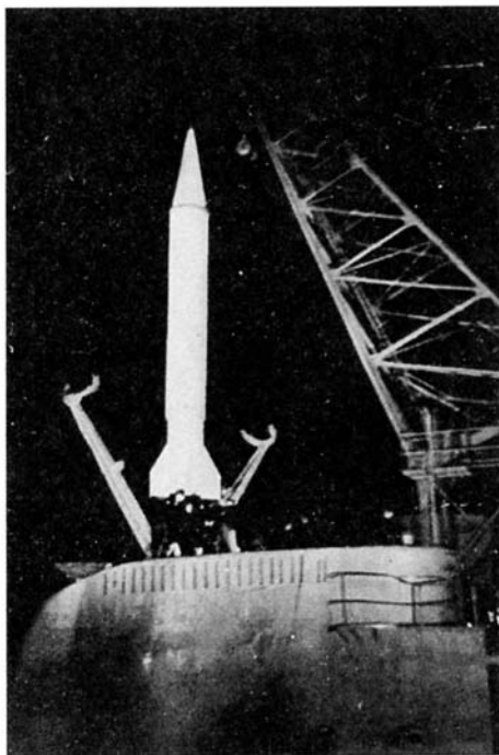
Погрузка ракеты Р-11ФМ на подводную лодку
