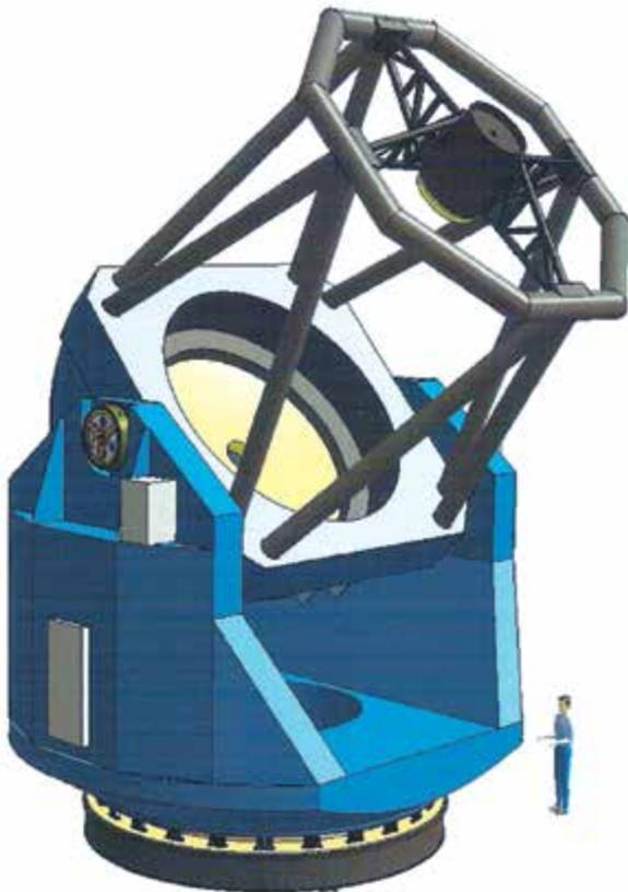
ме Ричи-Кретьен со светосилой (F/D), равной 9, включает первичное вогнутое и вторичное выпуклое гиперболические зеркала. В такой базовой конфигурации почти полностью устранена сферическая аберрация и кома. Из-за большого размера поля зрения (10 угловых минут), между вторичным зеркалом и фокальной плоскостью добавлен оптический Корректор Плоского Поля. Этот корректор предназначен главным образом для выравнивания поля. Оптическая схема корректора включает в себя 3 линзы.
