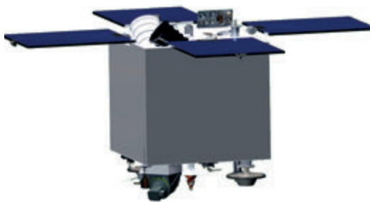
Космический аппарат «Січ-2-1» для наблюдения Земли с разрешением 8 м
