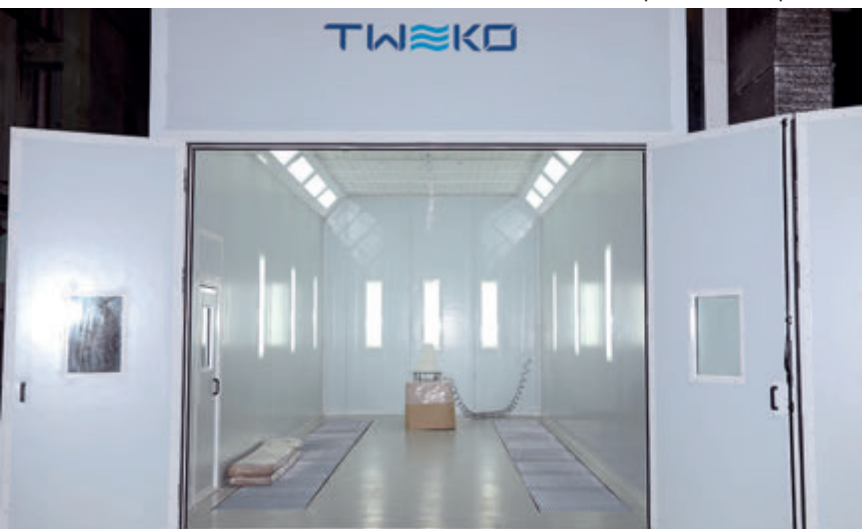
Камера для нанесения теплозащитного и лакокрасочного покрытий
