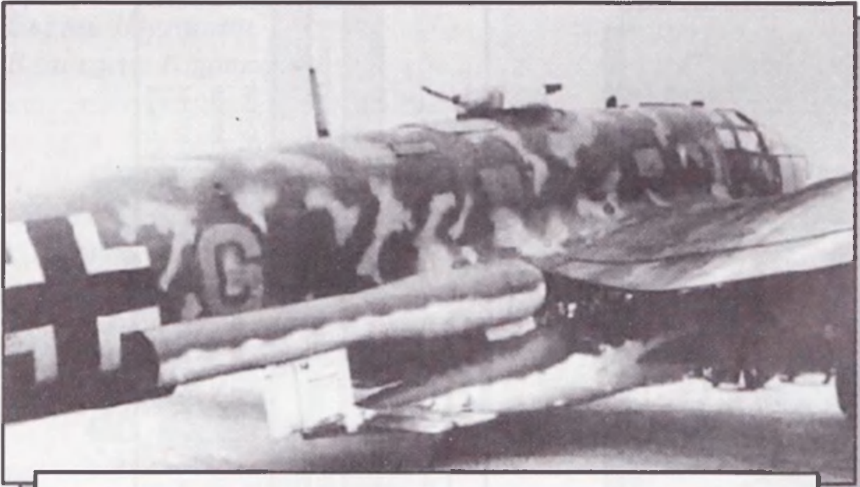
Бомбардировщик He 111H-22 с подвешенным самолетом-снарядом Fi 103
