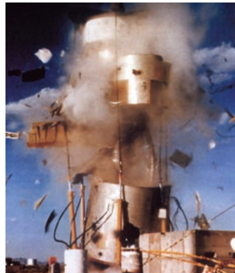
Выстрел химическим лазером MIRACL по второй ступени ракеты «Титан-1» показал, что за несколько секунд можно уничтожить баллистическую ракету на активном участке ее траектории.
