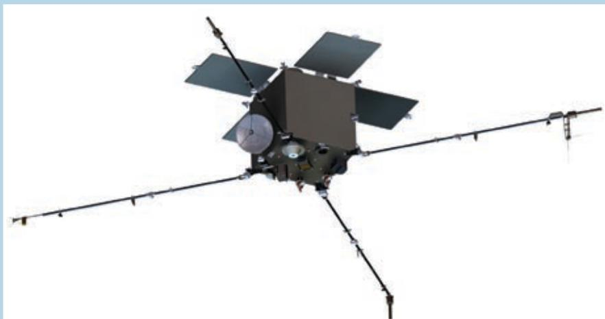
«Микросат». Аппарат на базе микроплатформы для проведения серии научных и технологических экспериментов в условиях космического пространства с использованием аппаратуры украинского производства
