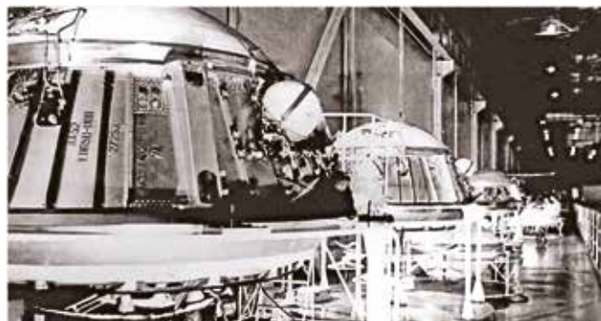
Блоки Е в сборочном цехе
