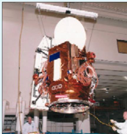
На GFO установлен резервированный комплект приемников спутниковой навигационной системы GPS, обеспечивающий СКО определения радиальной компоненты 10 см. Стабильные осцилляторы и доплеровские радиомаяки, ранее стоявшие и на КА «Geosat», позволяют определять орбиту КА с СКО по радиус-вектору 1.8 см.
