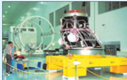
должен будет служить стыковочным узлом для шаттлов в последующих полетах к МКС. Доставка этого адаптера позволит перенести на станцию грузы из кабины шаттла или модуля снабжения в грузовом отсеке через внутренние люки.
