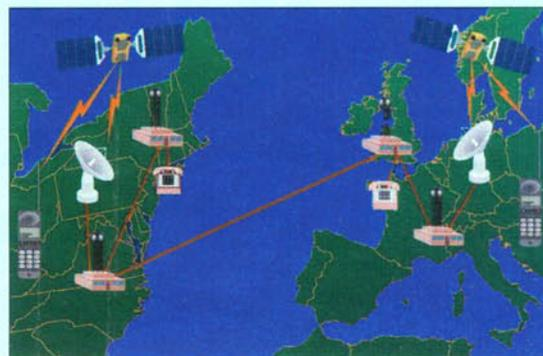
Схема наземного сегмента системы Globalstar
