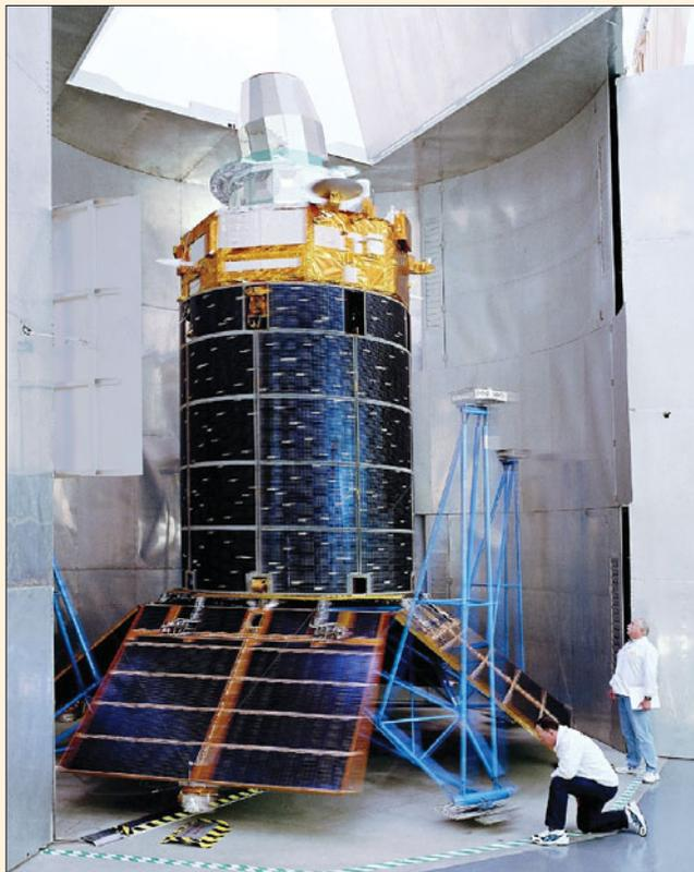
Спутник DSP F-22 на балансирующем стенде компании Northrop Grumman
