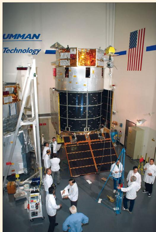
Испытания раскрытия СБ на DSP F-22
