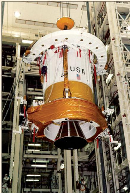
Разгонный блок IUS, выводящий телескоп Chandra
