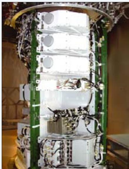
Контур бортового синхронизирующего устройства
