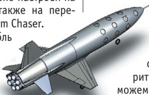
На вертикально запускаемом «Охотнике» должны использоваться связи гибридных ракетных двигателей (ГРД). Управляемый вход в атмосферу по сравнительно пологой траектории – после достижения высоты полета не менее 65 миль (примерно 105 км) – позволит снизить перегрузки по сравнению с характеристиками других проектов. Корабль будет также иметь много больших окон для того, чтобы пассажиры могли наслаждаться видом Земли и космоса во время суборбитального путешествия.
