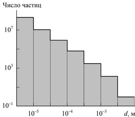
Рис. 1.8. Число частиц, образующихся за счет столкновений техногенных тел в интервале высот  $900\text{--}1100 \text{ км}$  в течение года
