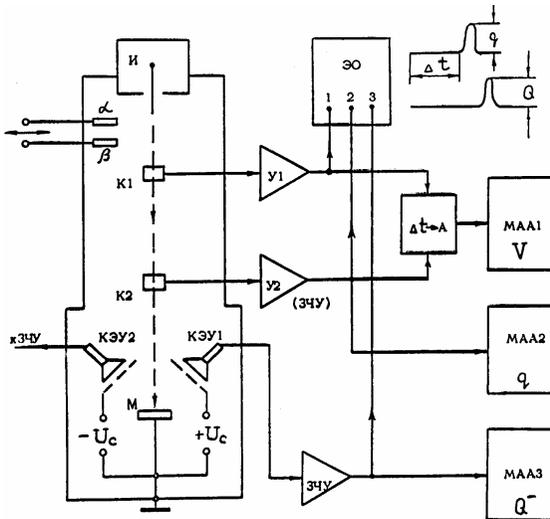
Рис. 2.8. Схема лабораторной установки: И – источник ускоренных частиц; K1, K2 – кольцевые индукционные датчики; M – мишень; КЭУ1, КЭУ2 – каналные электронные умножители; У1, У2 – усилители; ЗЧУ – зарядочувствительные усилители; ЭО – двухлучевой осциллограф с памятью; АА – многоканальные амплитудные анализаторы;  $\alpha$ ,  $\beta$  – радиоактивные калибровочные источники
