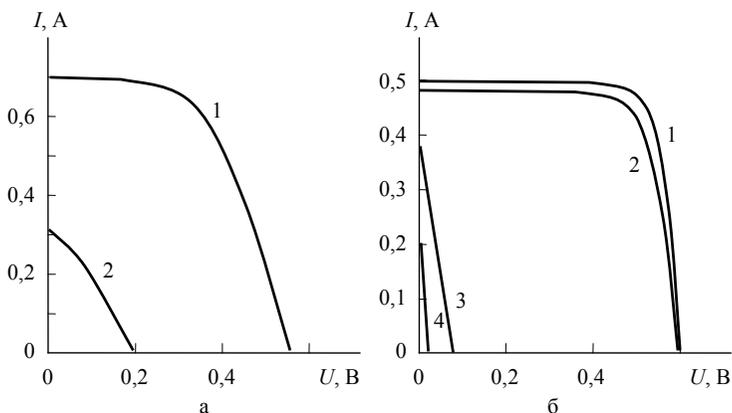
Рис. 5.2. Зарегистрированные изменения вольт-амперных характеристик ФЭП СБ: а – в лабораторном эксперименте; б – в натуральных условиях
