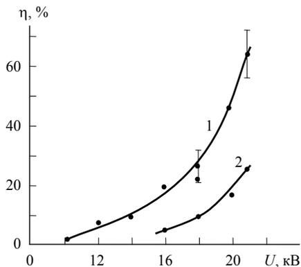
Рис. 3.13. Вероятность инициирования электрического пробоя в вакуумном промежутке при бомбардировке сплошного электрода микрочастицами: 1 – при отрицательном напряжении на сплошном электроде; 2 – при положительном напряжении
