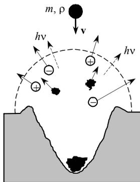
Рис. 3.2. Схема образования кратера в пластичной мишени
