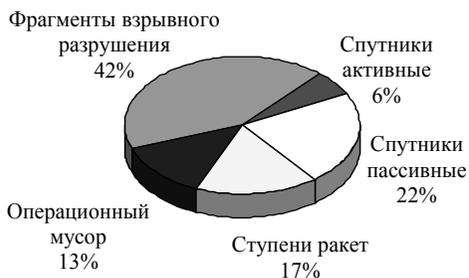
Рис. 1.4. Состав техногенных объектов на низких околоземных орбитах
