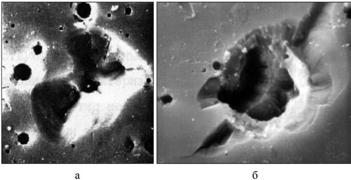
Рис. 3.9. Кратеры, образованные в пластине Ge ударами Ti частиц с поперечными размерами  $d \sim 0,5\text{--}1,5$  мкм и скоростями  $v \sim 4\text{--}6$  км·с<sup>-1</sup>
