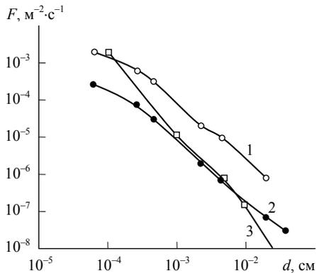
Рис. 1.19. Результаты прямых измерений и модельных расчетов зависимости потока микрочастиц  $F$  от их диаметра  $d$ : 1, 2 – экспериментальные данные для лобовой и тыльной поверхности ИСЗ LDEF соответственно; 3 – результаты модельных расчетов для экспериментов на КА EURECA и HST
