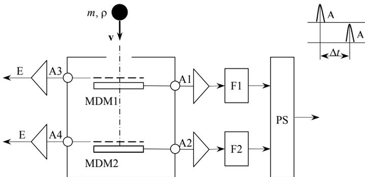
Рис. 4.2. Схема прибора с двумя тонкопленочными конденсаторными датчиками
