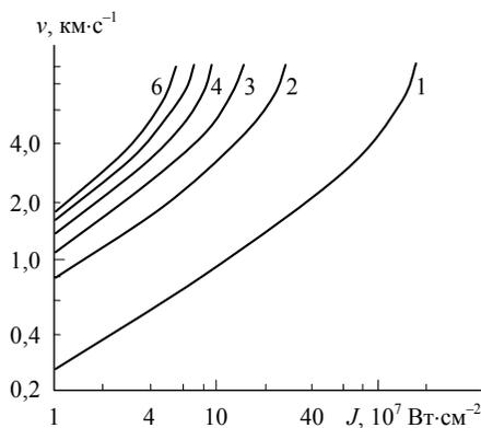
Рис 2.7. Зависимость скорости  $v$  алюминиевого диска диаметром 300 мкм от плотности поглощенного потока энергии при различных толщинах ускоряемого диска, [мкм]: 1 – 15,3; 2 – 2,75; 3 – 1,9; 4 – 1,6; 5 – 1,5; 6 – 1,4
