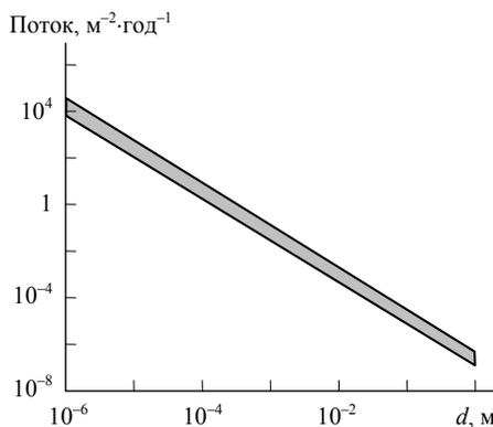
Рис. 1.12. Зависимость плотности потока техногенных тел от их диаметра на орбите МКС (высота 400 км, наклонение 51,6°)
