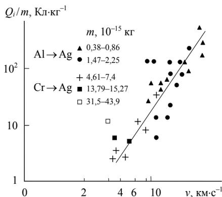
Рис. 3.10. Зависимость удельного эмитируемого ионного заряда от скорости бомбардирующих частиц
