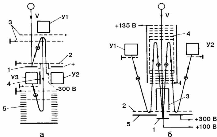
Рис. 4.5. Схемы времяпролетных масс-спектрометров с электростатическими зеркалами
