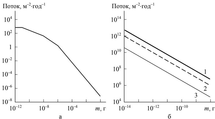
Рис. 1.16. Интегральный массовый спектр метеороидов (а) и вторичных частиц, выбрасываемых из области удара, при скоростях частиц, [км·с<sup>-1</sup>]: 1 – 0,1; 2 – 0,25; 3 – 1,0 (б)
