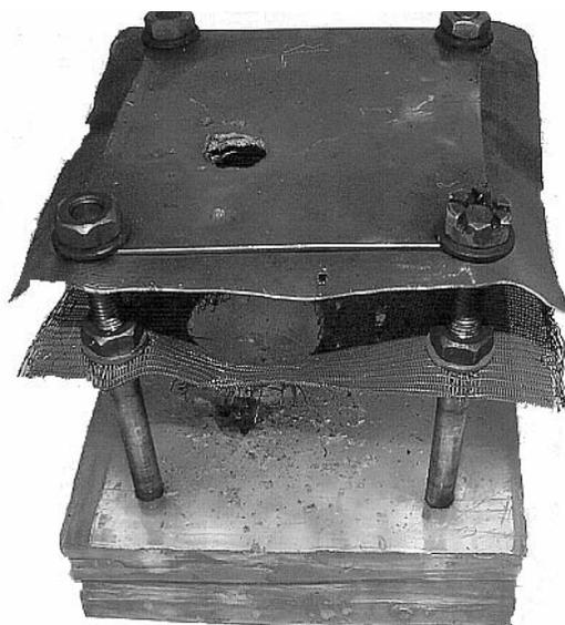
Рис. 5.4. Макет комбинированного защитного экрана после воздействия частицы массой 1 г со скоростью  $\sim 6 \text{ км}\cdot\text{с}^{-1}$
