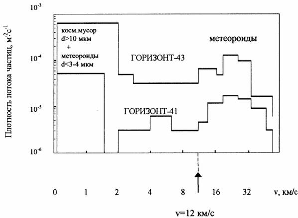
Рис. 4.4. Результаты измерения плотности потока микрочастиц естественного и искусственного происхождения с поперечными размерами  $d = 1-1000$  мкм в области ГСО
