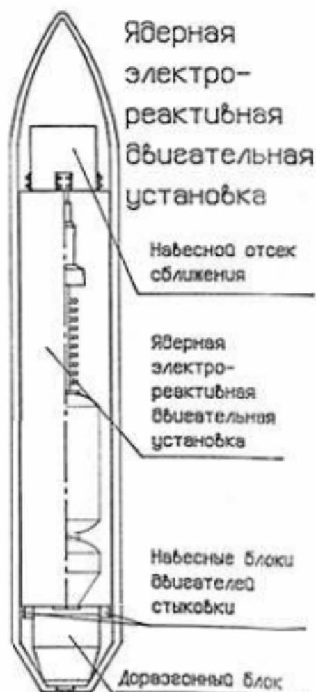
Тяга направлена перпендикулярно местной вертикали и лежит в плоскости орбиты в направлении разгона. При этом МЭК движется по раскручивающейся спирали вокруг Земли.
