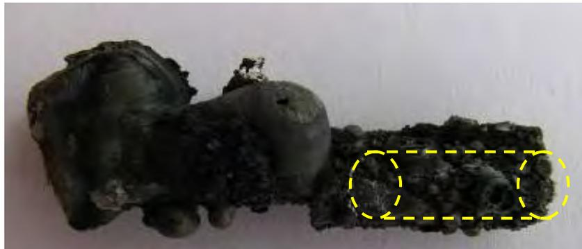
Рис. 14. Титановая подложка, покрытая продуктом СВС, полученным в условиях микрогравитации
