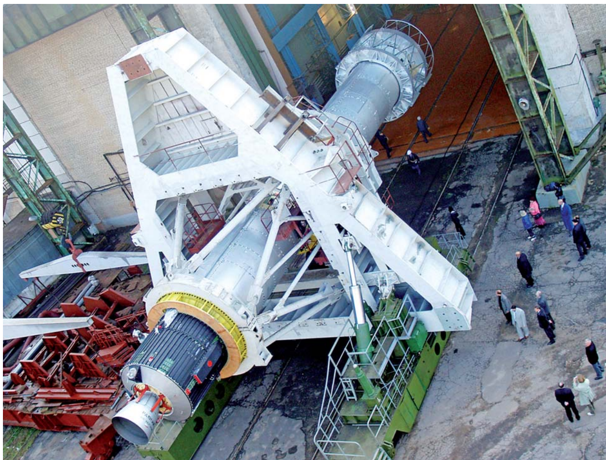
Универсальный ракетный модуль УРМ-1 ракеты-носителя «Ангара» на установщике перед проведением огневых стендовых испытаний (вывоз из МИКА на стенд ИС-102).
