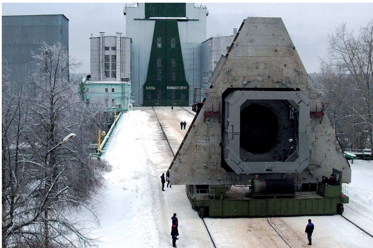
Вывоз УРМ-2 РН «Ангара» со стенда ИС-102 после огневых испытаний. Декабрь 2010 г. Модуль в установщике.
