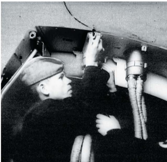
*Стыковка разъёма на РН «Космос-3М»*
