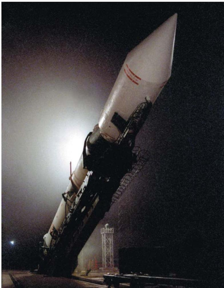
*Установка РН «Циклон-3» в вертикальное положение на СК*
