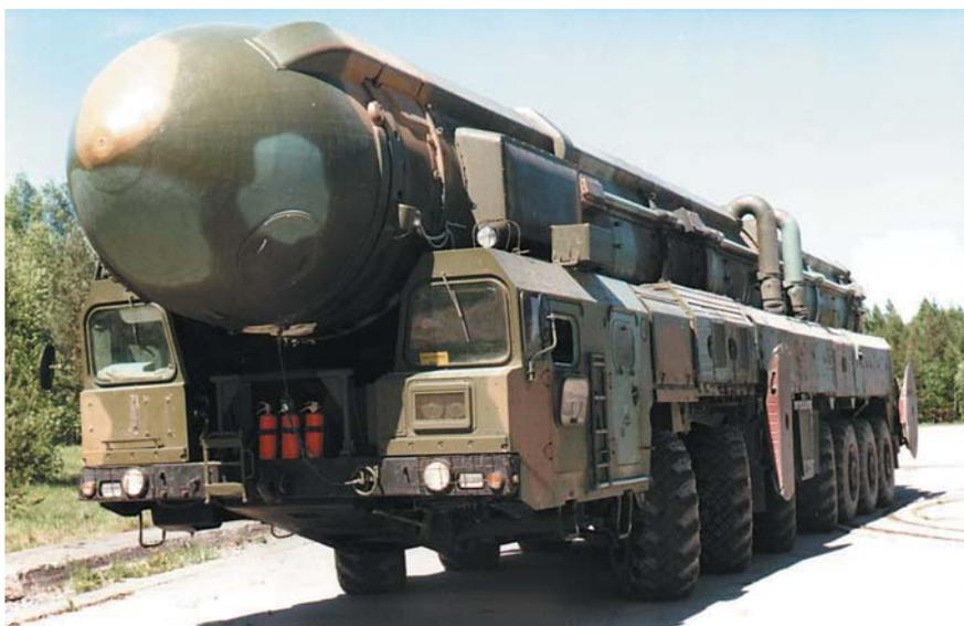
*Пусковая установка ракетного комплекса «Тополь»*
