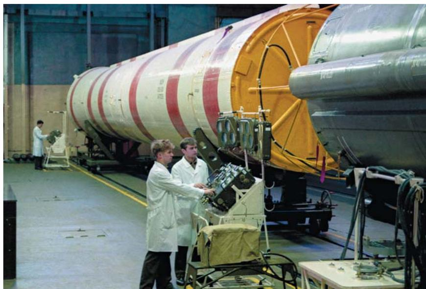
*Пневмо-вакуумные испытания РН «Космос-3М». 1989 год*
