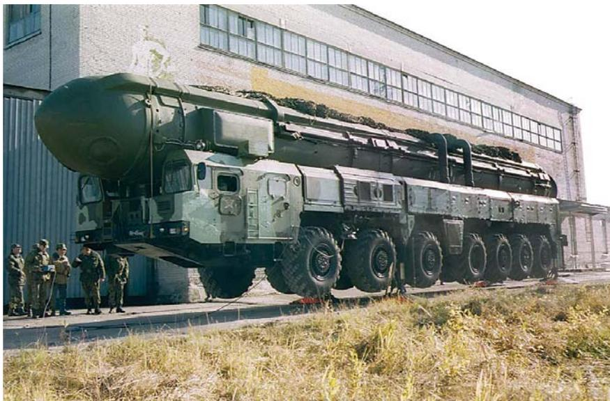
Пусковая установка ракетного комплекса «Тополь»
