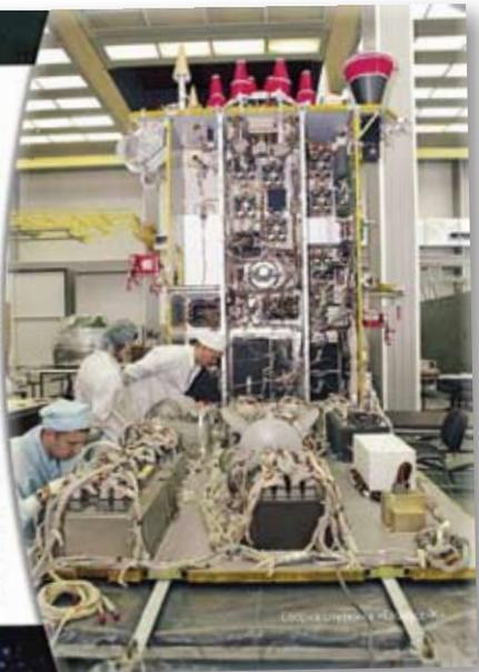
Любые спутники «кружатся» бортовой комплекс, управление. Это компьютер, рассчитанный на высокую степень автономности. Но до того как спутник «завершит» свою миссию — отправит в космос, он должен пройти длительные испытания. В течение нескольких месяцев сам спутник или его элементы тестируют и проверяют, помещают в вакуум и подвергают воздействию радиации.
