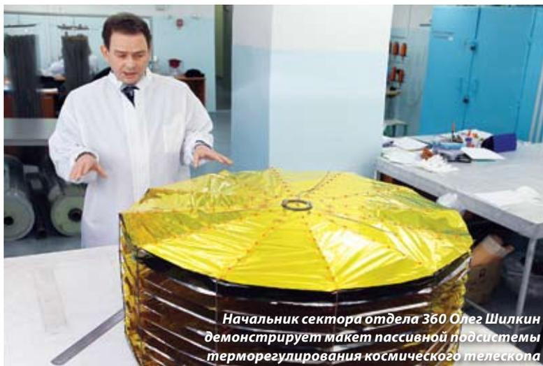
Начальник сектора отдела 360 Олег Шилкин демонстрирует макет пассивной подсистемы терморегулирования космического телескопа
