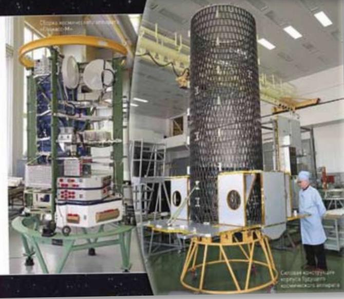
Корпус спутника, который летал в космос 20 лет назад, был из алюминия, титана и бериллиевых сплавов. Сейчас всё большее применение находят углепластиковые композиционные материалы. Дальнейшее развитие материалов для спутника будет связано с применением нанотехнологий. В структуру металла начинают вводить наночастицы, которые увеличат его прочность и жесткость.
