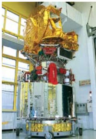
поставила на предприятие бортовой ретрансляционный комплекс. Аппарат оснащён четырьмя антеннами, выполненными по новым технологиям. Три из них являются перенацеливаемыми, что создаёт дополнительные возможности для операторов спутниковой связи. Космический аппарат решает задачи по обеспечению цифрового телерадиовещания, доступа к сети Интернет, организации видеоконференц-связи, а также используется для подвижной правительственной и президентской связи.
