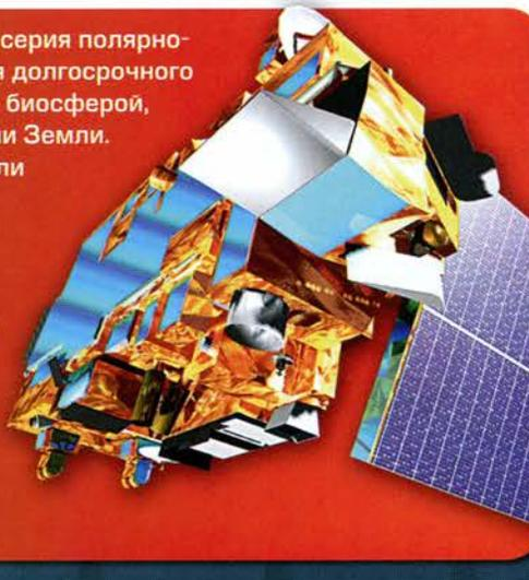
кие изображения поверхности Земли. Спутник проходит по орбите один раз в 99 минут на высоте 705 км. Его сестринский аппарат, «Аква», пересекает экватор в 13:30, дополняя и расширяя измерения и возможности «Терры».
