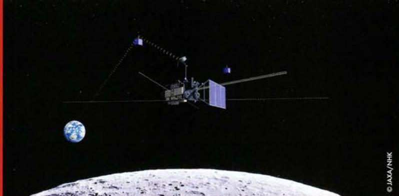
**ЛАЗЕРНЫЙ АЛЬТИМЕТР** На снимке показано, как лазерный альтиметр SELENE производит высокоточные измерения высоты лунной поверхности.
