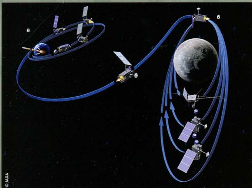
**МАРШРУТ ПОЛЕТА** SELENE запустили на орбиту Земли (а), затем он вышел на траекторию по направлению к Луне, в результате чего благодаря еще одному маневру (б) спутник вышел на лунную полярную орбиту.
