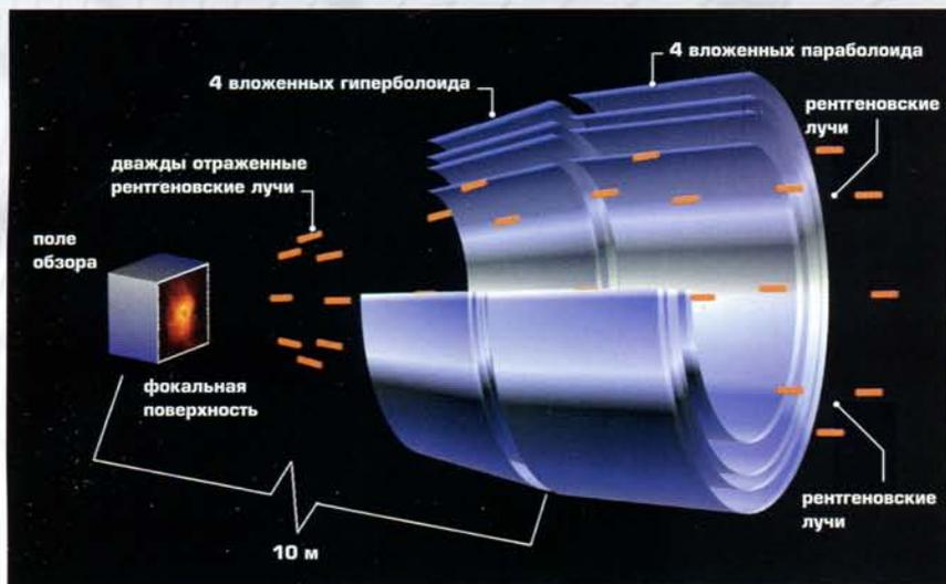
ков поля обзора «Чандры» и сводят его в единый снимок. Недостаток методики скользящего падения заключается в больших зазорах между зеркалами, в которые может проходить рентгеновское излучение. В результате, несмотря на общий диаметр телескопа в 140 см, фактическая приемная поверхность намного меньше.
