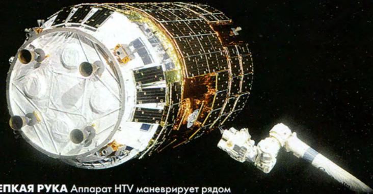
**КРЕПКАЯ РУКА** Аппарат НТВ маневрирует рядом с МКС, а роботизированный манипулятор (справа) захватывает и удерживает его.
