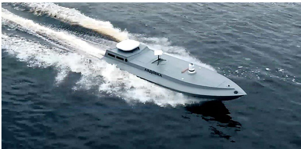
«Авдиивка», улучшенный вариант БНА «Дитя моря». Большая белая антенна – «Старлинк». Маленькая – «Кимета». Перед ней – электронно-оптический сенсор.
