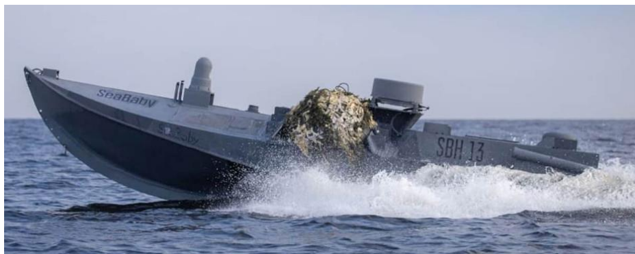
БНА «Дитя моря», несущий в корме 6 пусковых труб для 122-мм ракет
