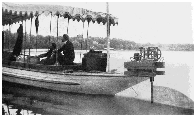
Аппаратура управления на корме «Фриды»
