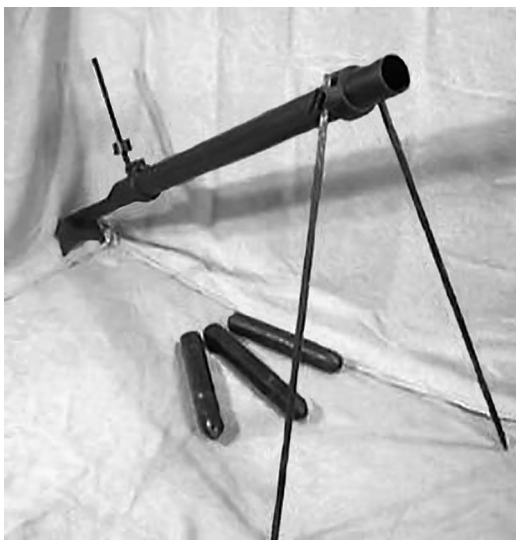
Пусковая труба для ракет Хейла калибра 3,5 дм (89 мм) времен Гражданской войны
