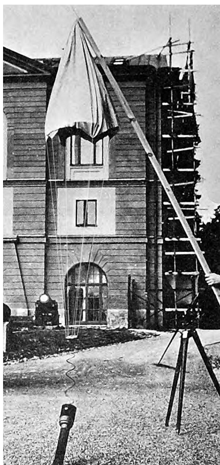
Внизу — шведская осветительная ракета образца 1830 г.; вверху — её раскрытый парашют
