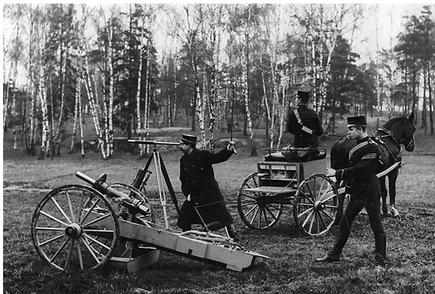
Пневматическая пусковая установка с вращающейся трубой калибра 6 см для ракеты Унге (1894)
