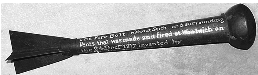
Зажигательная ракета Конгрева, испытанная 24 декабря 1817 г. в Вулвиче. Вместо шеста у нее хвостовое оперение
