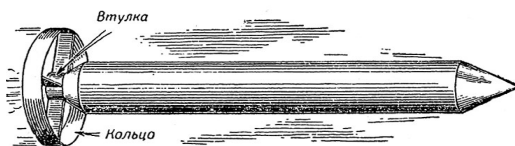
Трехдюймовая (76-мм) ракета Поморцева с кольцевым стабилизатором. Ракеты с таким стабилизатором, при весе от 10 до 12 кг, пущенные под углом 30–40° к горизонту, летели (в зависимости от ветра) на 3–6 км
