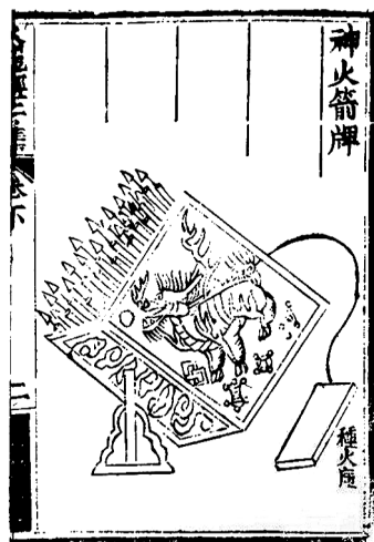
«Щит божественных огненных стрел» — пусковая установка залпового огня
