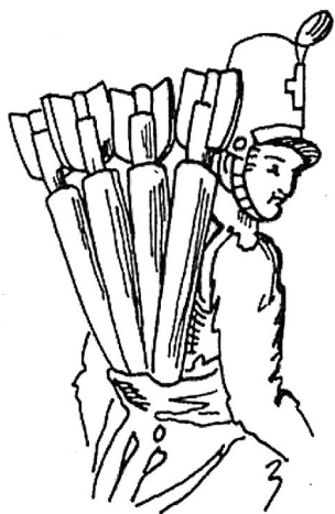
Солдат переносит 4 ракеты в наплечном ранце на спине. Он легко прикрепит крылья с помощью проволочных шпилек в нужное время
