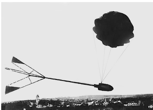
Головная часть ракеты с фотокамерой спускается на парашюте
