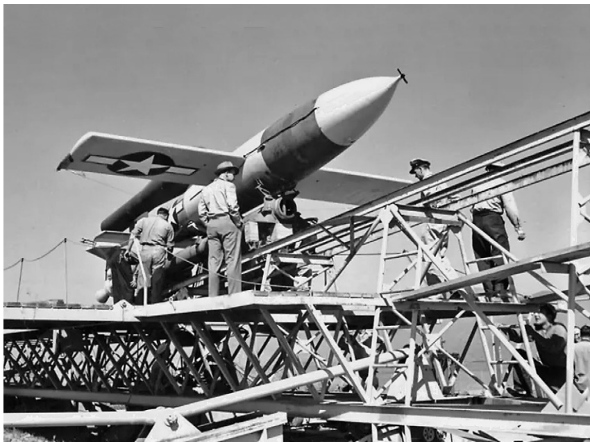
Подготовка самолета-снаряда JB-2 «Loon» к пуску с наземной установки
