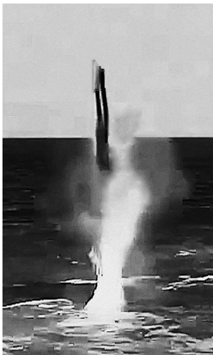
Дрон «Ninox 103» выстреливается в транспортно-пусковом контейнере
