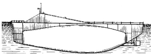
Поперечные сечения авианосца Э. Ортеги. Слева — с носа; справа — с кормы
