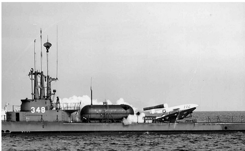
Запуск «Loon» с подводной лодки SS-348 «Cusk» (1951 г.)
