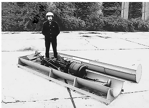
Разобранный макет вертолётного подводного базирования в контейнере диаметром 53 см
