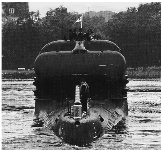
Лодки пр. 665 несли 4 контейнера ракет в надстройке, слитой с ограждением рубки
