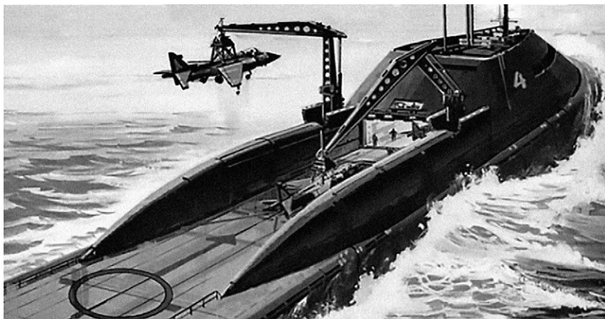
Британский подводный авианосец с самолетами ВПП. Проект на основе АПЛ «Vanguard» (14000/15850 т; 149,3 × 12,8 × 10 м)
