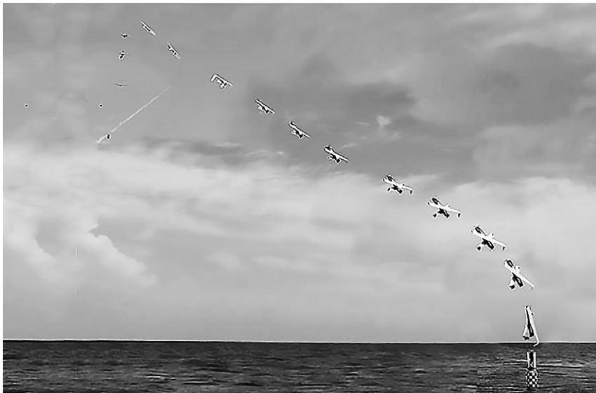
Система «Sea Robin»: взлёт дрона XFC и переход его в горизонтальный полёт
