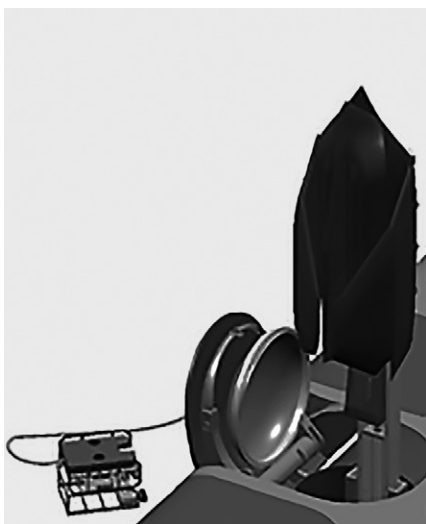
Дрон убирается в шахту. Слева — плавающий робот-буксировщик
