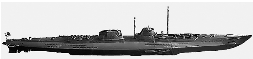
Макет подводного крейсера проекта 50 (UD-1) с паровыми турбинами. Между орудием № 2 и ограждением рубки находится гидроплан «Роланд»
