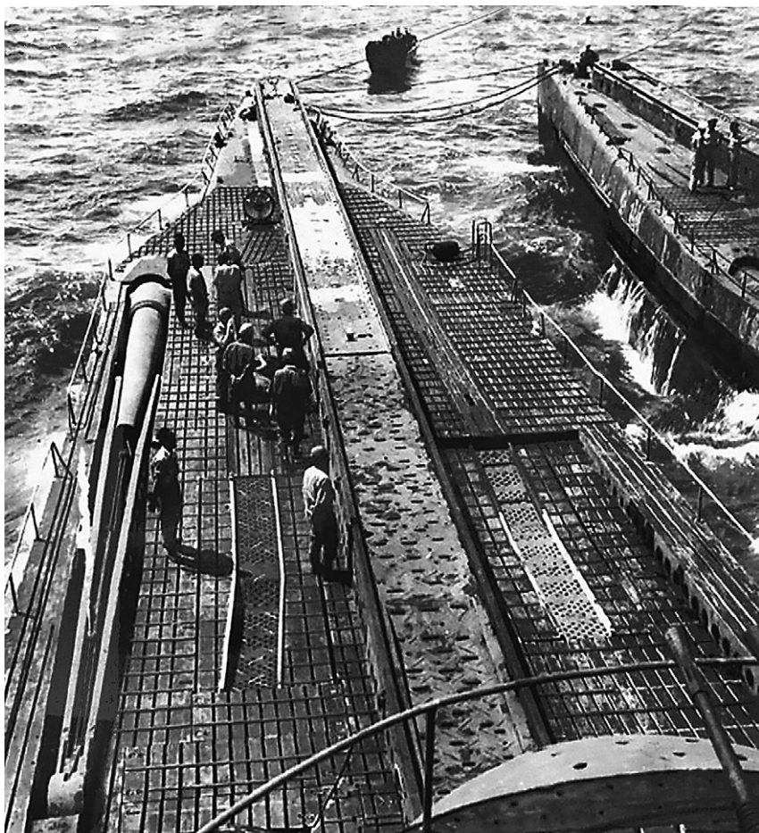
Стартовый трек пневматической катапульты I-400. Слева сложенный подъемный кран грузоподъемностью 12 тонн. Фото 29 августа 1944 г.
