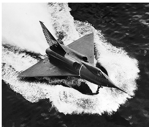
«Sea Dart» на взлёте. У него были две гидролужи; крылья складывались вверх
