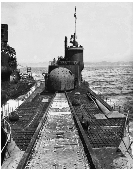
Вид трека катапульты I-14 от форштевня. Кран (справа) уложен в выемку
