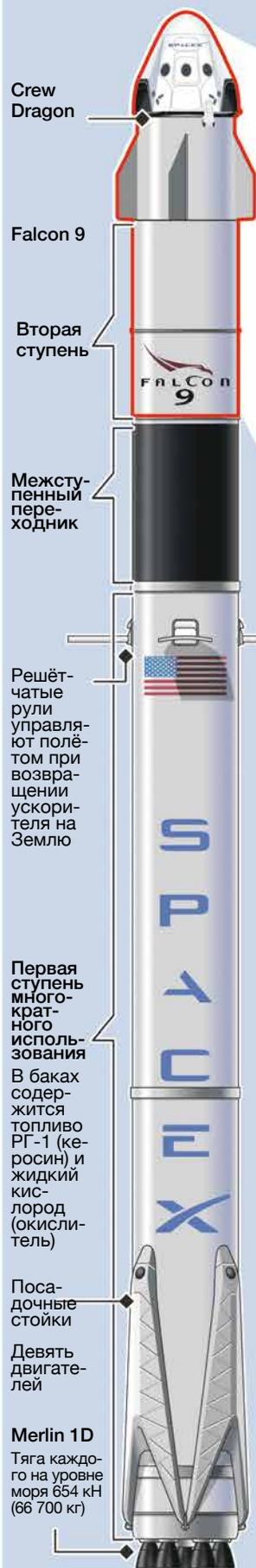
**Грузовой отсек:** Перевозка груза без герметизации. Солнечные панели покрывают половину поверхности. Отсек отбрасывается перед возвращением
