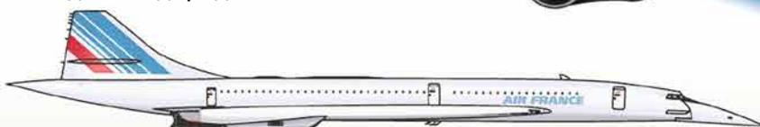
**Тепло вырабатывается за счёт сжатия воздуха на входе в двигатель.** Например, в двигателях сверхзвукового самолёта «Конкорд» температура доходила до 160°C при 2 Махах (2140 км/ч)
