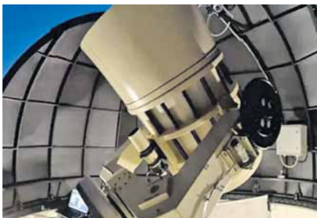
Телескоп с диаметром 0,65 м, с помощью которого Борисов сделал своё великое открытие, позволяет наблюдать небесных «гостей» с яркостью до 20-й звёздной величины
