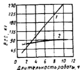
Рис. 1. Сравнение веса аккумуляторов и топливных элементов 1 — аккумуляторы; 2 — топливные элементы
