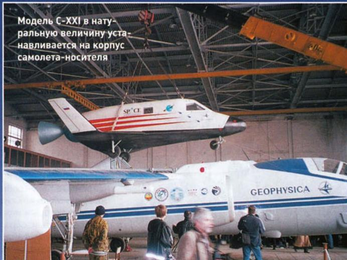
Модель С-XXI в натуральную величину устанавливается на корпус самолета-носителя
