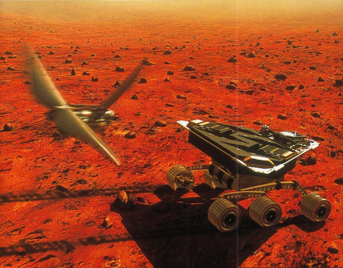
«Энтомоптер», созданный, чтобы работать в автономном режиме, будет изучать марсианскую поверхность с высоты 30 метров. Иллюстрации показывают взлет и посадку робота с передвижной платформы.
