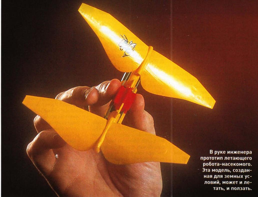
В руке инженера прототип летающего робота-насекомого. Эта модель, созданная для земных условий, может и летать, и ползать.
