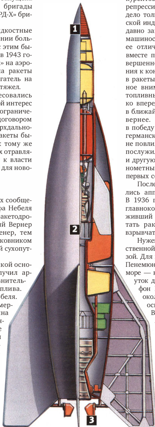
1 — боевая часть, 2 — двигатель, 3 — газоструйные рули
