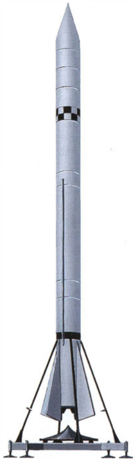
Тактическая баллистическая ракета SSM-A-17 Corporal, США, 1953 г. Дальность полета — до 120 км. Боевая часть ядерная (до 100 кт). Пуск со стола
